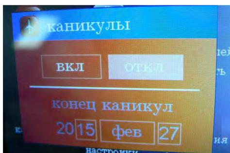
Как только вы установили «каникулы», регенерация клапана переходит на два цикла: обратная промывка и прямая промывка. Пункт меню «дополнительные настройки» принимает следующий вид:
