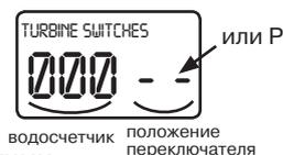
Используйте клавишу **Recharge** для того, чтобы вручную перевести клапан в положение каждого из циклов и проверить правильность работы микровыключателя В.
